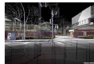
「デジタル芸大」 (gluon+クモノス、東京芸大金田研究室) 上野にある東京芸術大学のキャンパス空間をまるごとデジタルスキャン。物理的なキャンパスとデジタル空間を組み合わせた「コモングラウンド」を構築。リアルな物理空間と、デジタルの情報が重層的に存在する空間で、自律走行の検証やゲーム実装などの試験的な実証実験を試みている。また、点群データは学生やクリエイターの方々に公開され、デジタルのキャンパス内で多種多様な表現手法や楽しみ方が生まれた。
